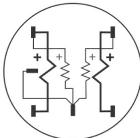
Meter Internal Wiring
