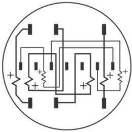
Meter Internal Wiring
