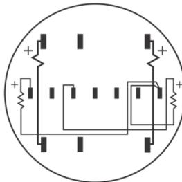
Meter Internal Wiring
