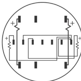
Meter Internal Wiring
