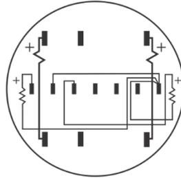
Meter Internal Wiring
