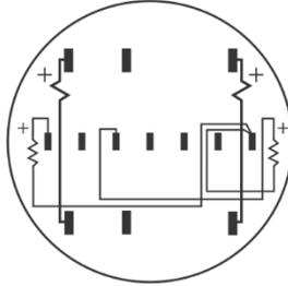
Meter Internal Wiring
