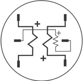
Meter Internal Wiring
