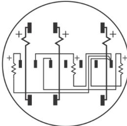
Meter Internal Wiring
