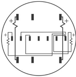
Meter Internal Wiring
