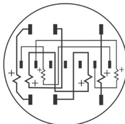
Meter Internal Wiring
