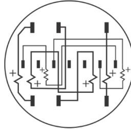
Meter Internal Wiring
