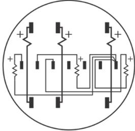
Meter Internal Wiring
