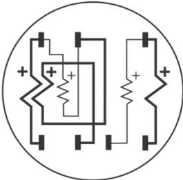
Meter Internal Wiring
