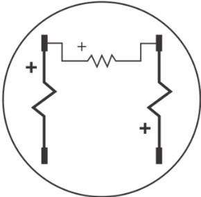
Meter Internal Wiring
