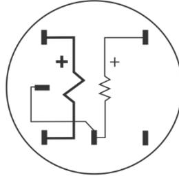
Meter Internal Wiring
